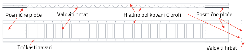
Slika 1. CWB nosač i njegove komponente
