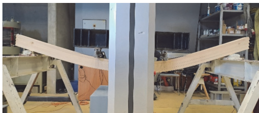
Slika 4. Linijski element neposredno prije otkazivanja
