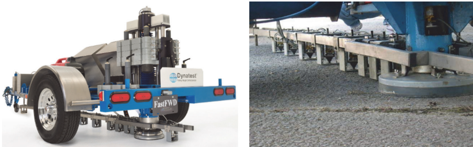
Slika 2. Uređaj za ispitivanje defleksija: a) deflektometar s padajućim teretom; b) uvećani prikaz kružne ploče za prijenos opterećenja [5,8]
