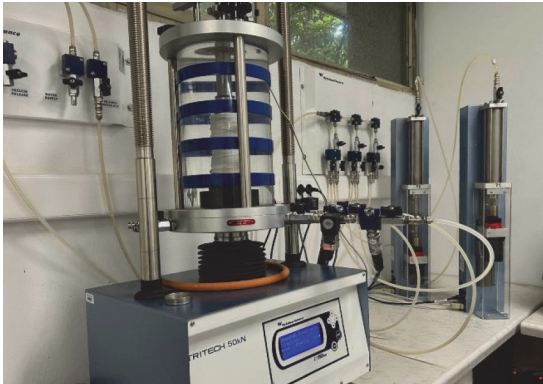
Slika 3. Troosni uređaj za provođenje UU pokusa i stanje naprezanja u uzorku
