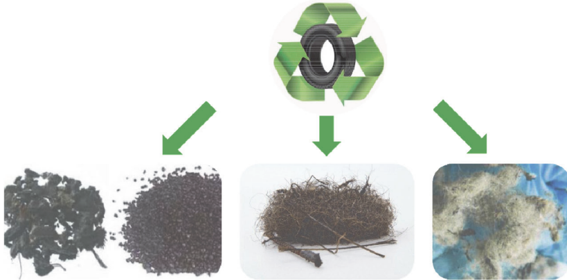
Slika 1. Sastavni dijelovi auto guma: guma, čelična vlakna, polimerna vlakna
