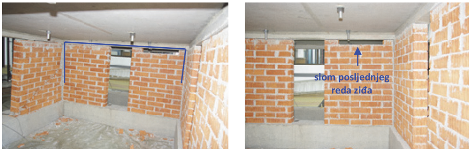
Slika 2. Slom okomito na svoju ravninu ispunškog zida poprečnog okvira prizemlja
