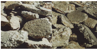
Slika 4. Stari beton prije reciklaže [4]
