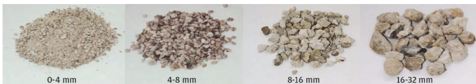
Slika 5. Stari beton nakon prerade (frakcije recikliranog agregata) [4]
