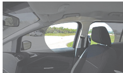
Slika 6. B-nosač krova i njegov utjecaj na vidno polje (Izvor: www.oeamtc.at)
