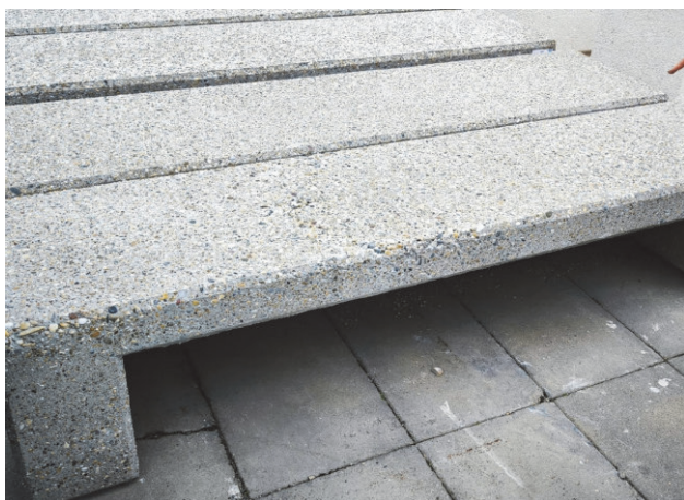
Slika 5. Betonska klupa sa 6 % PDB-a zamjene agregata (pilot-projekt u Klinča Selima)
