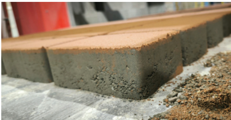
Slika 2. Predgotovljeni opločnici (osnovni sloj – beton s miješanim cementom sa 16 % PDB-a)
