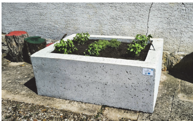
Slika 4. Betonske žardinjere sa 6 % PDB-a zamjene agregata (dio „mini” pilot-projekta u Osnovnoj školi Mušaluk)
