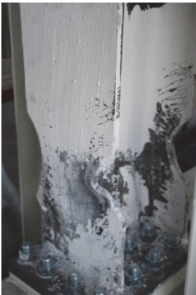
Slika 5. Prikaz oštećenog mjesta u djelomično zavarenoj izvedbi, te prijedlog načina sanacije [18]
