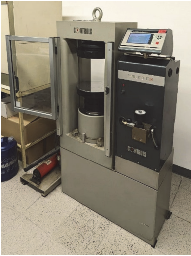
Slika 1. Uređaj za provođenje pokusa jednoosnog tlaka i stanje naprezanja u uzorku
