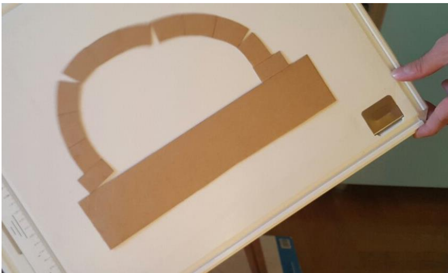
Slika 26. b) otvaranje pukotina tj. zglobova
