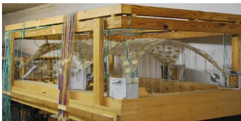
Slika 25.: Uređaj za ispitivanje modela ljuske tvornice Sicli (Izvor: [30])
