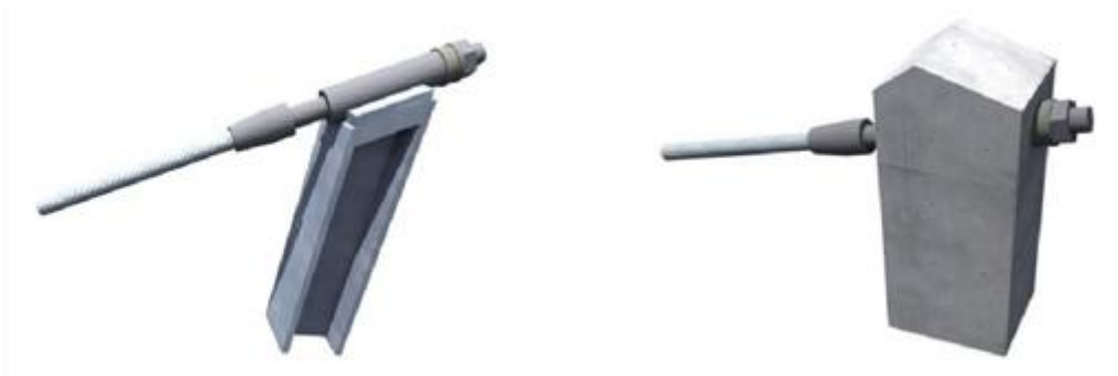
Slika 16. Lijevo: Priključak na čelični i betonski stup
