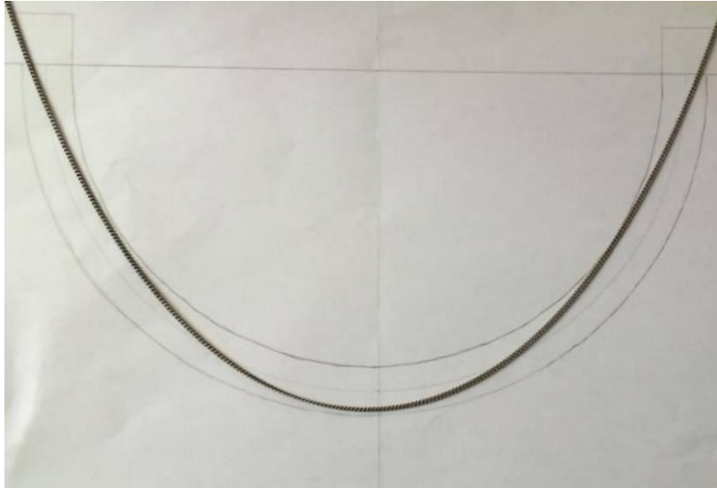
Slika 34. Tlačna linija kod povećanja raspona
