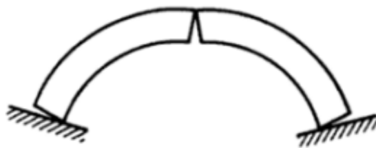
Slika 29. Formiranje zgloba zbog povećanja raspona
