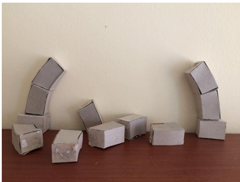
Slika 39. Prikaz nanošenja koncentrirane sile, razvoj pukotina te slom luka
