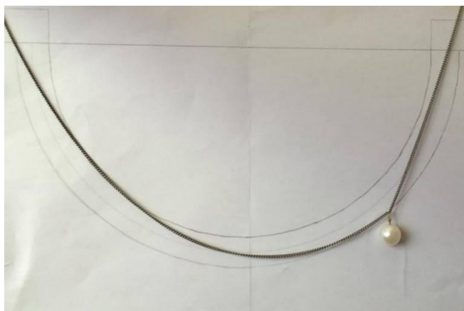
Slika 38. Prikaz tlačne linije kod djelovanja koncentriranog opterećenja
