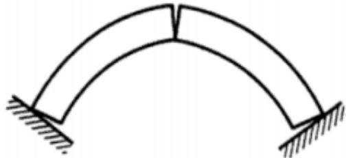
Slika 30. Formiranje zgloba zbog smanjenja raspona
