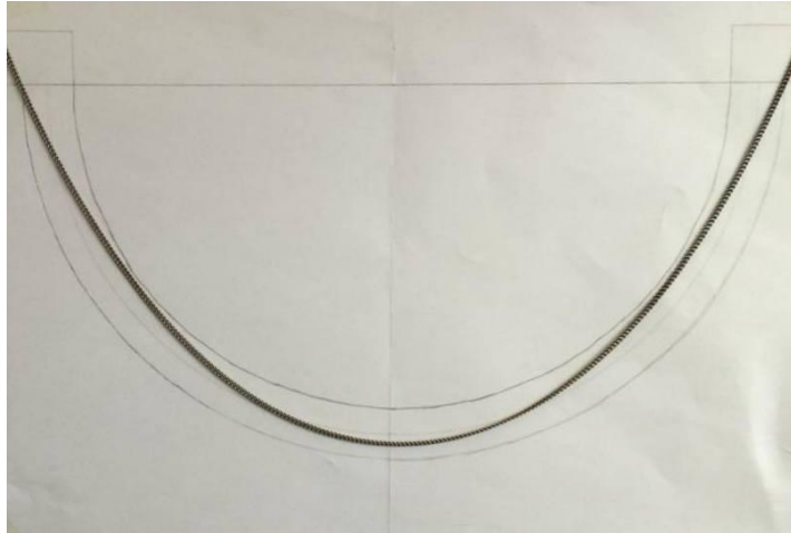
Slika 32. Tlačna linija unutar luka
