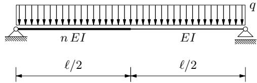
2. (15) Objasnite postupak izračunavanja zaokreta metodom jedinične sile. Na kojem se teoremu postupak temelji?
