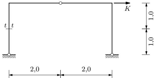
4. (25) Pomoću utjecajnih linija izračunajte  $T_{1-1}(K)$ ,  $M_{2-2}(K)$ , horizontalnu reakciju u srednjem i vertikalnu reakciju u lijevom ležaju.
