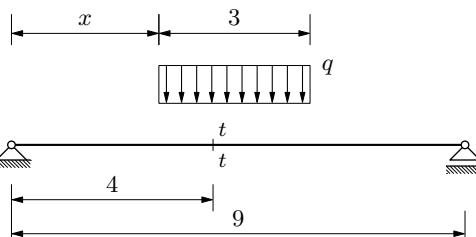
4. (15) Izračunati vertikalni pomak točke  $x = \ell/2$ .
