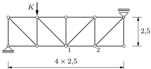
4. (20) Pomoću utjecajnih linija izračunati vertikalnu reakciju u ležaju A i poprečnu silu u presjeku t – t.
