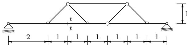
4. (15) Izračunati vertikalni pomak točke C.
