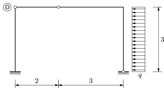
3. (10) Pomoću utjecajnih linija izračunati reakciju u ležaju B i poprečnu silu u presjeku  $t - t$ .
